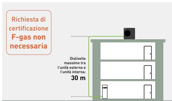
\* Per la serie L solo quando l'unità esterna è installata sopra l'unità interna e la pressione dell'acqua non supera 1 bar sull'unità esterna.
